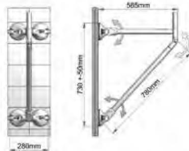
Maniglione a ventosa in grado di fornire un ampio supporto accanto ai sanitari del bagno, Quattro Power Support è un ausilio versatile che può essere spostato nell'angolazione preferita e collocato secondo le esigenze dell'utente in diverse posizioni.
